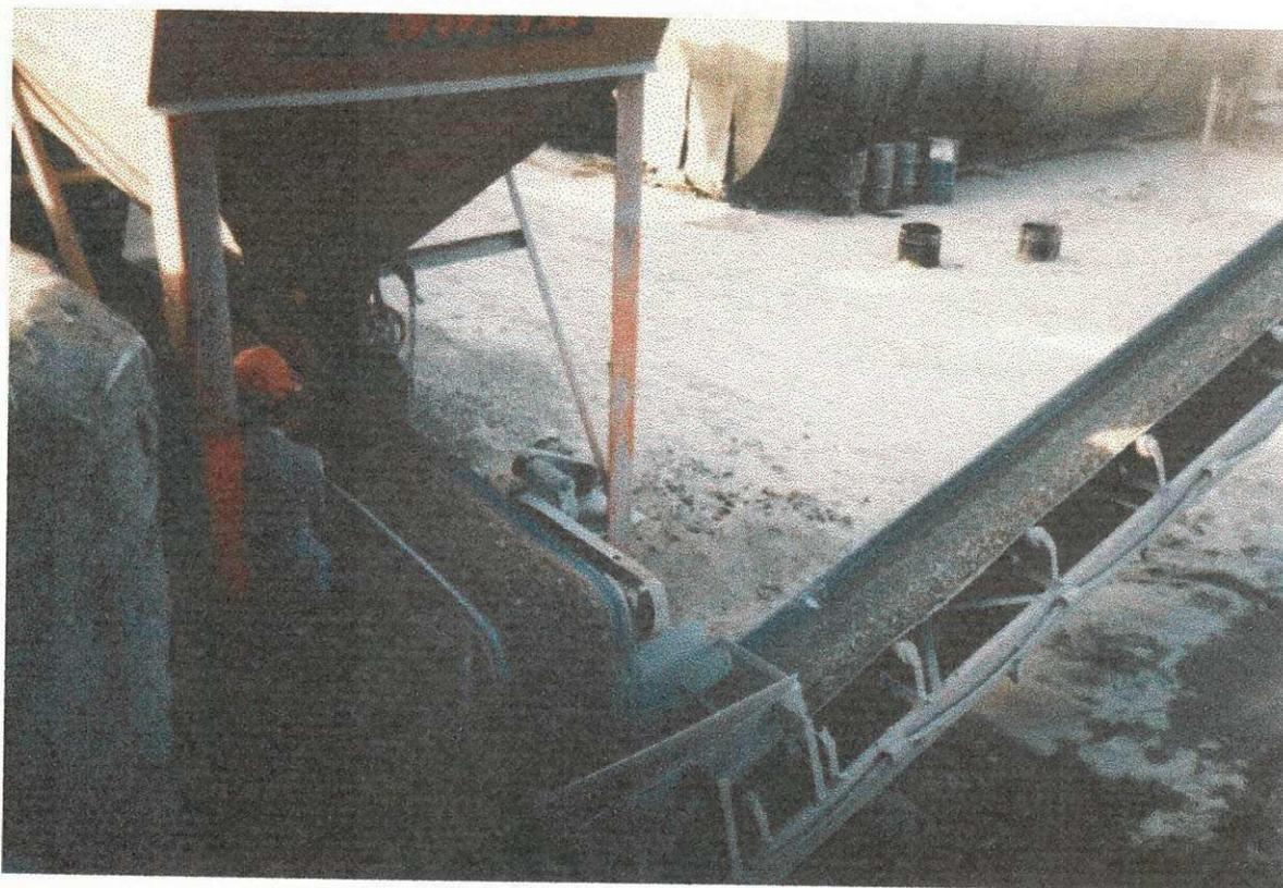
**FIGURA 5 – Esteira Coletora de Agregados**
