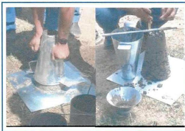
Figura 7 – Teste do Slump.
