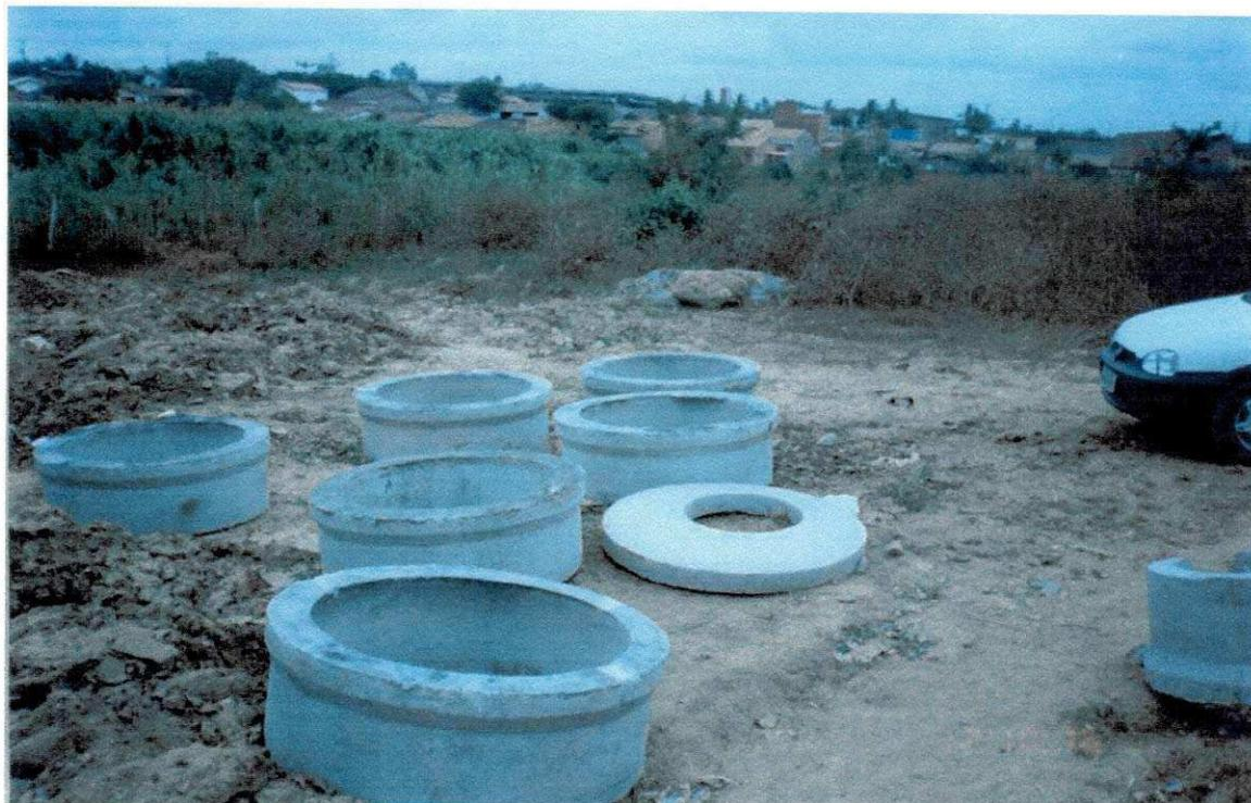
**FABRICAÇÃO DE ANÉIS PREMOLDADOS PARA
