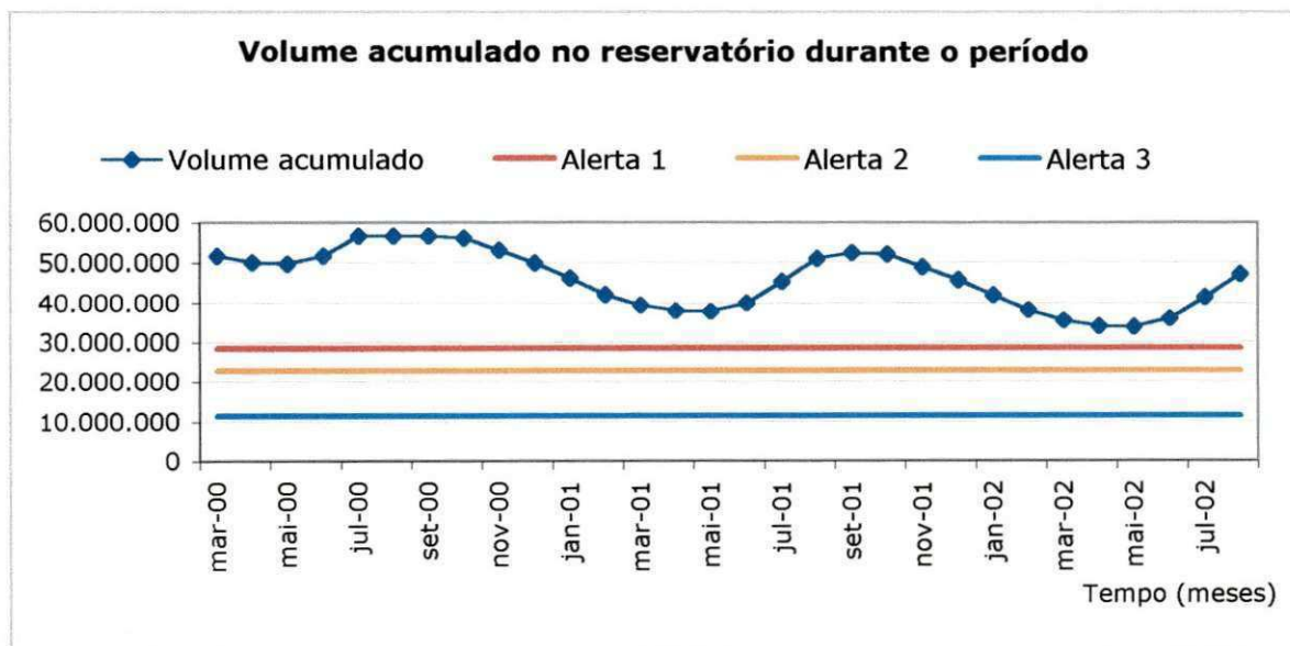
Figura 9 – Gráfico do Volume acumulado no reservatório durante o período, observando os níveis de alerta, definidos na planilha Alerta para o reservatório.
