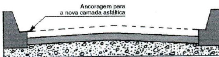
Figura 7: Fresagem contínua em toda a pista
