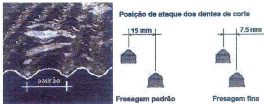
Figura 3: Comparação da posição dos dentes de corte entre a fresagem padrão e a fresagem fina.
