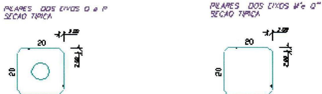
Figura 10 – seção transversal dos pilares
