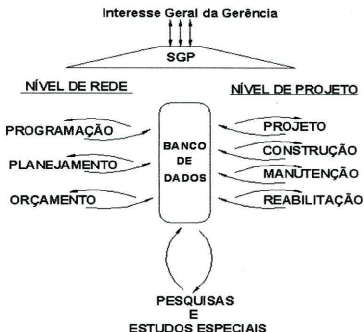
Figura 3 – Componentes principais de um Sistema de Gerência de Pavimentos Fonte: [LIMA, 2001 apud RODRIGUES, 2002]
