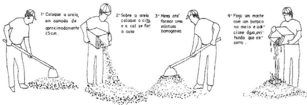
Figura 1 – preparo da argamassa manualmente
