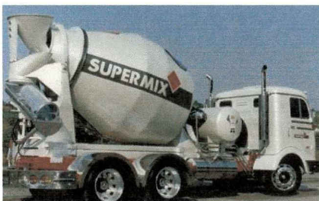
Figura 7 - Caminhão utilizado para transporte do concreto usinado.
