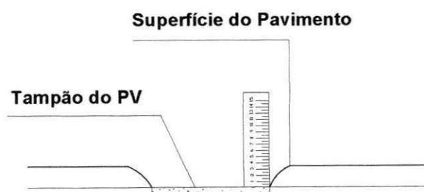
**Figura VI – Medição do nível da superfície do pavimento ao nível do tampão do poço de visita**
