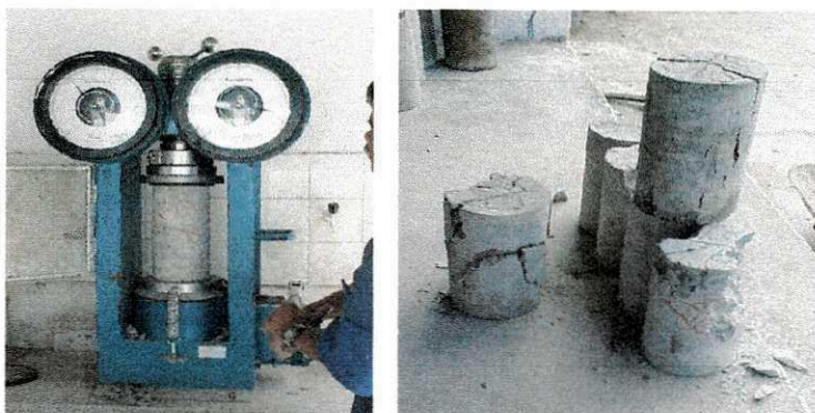
Figuras 18 e 19. Rompimento e visualização dos corpos de prova.
