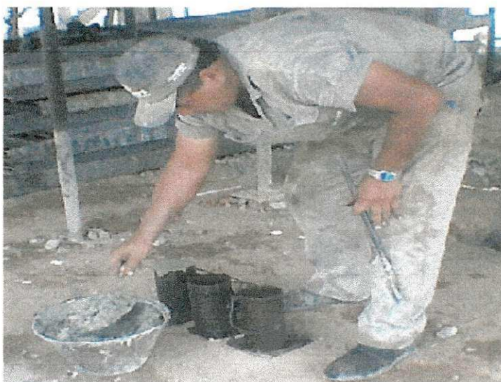
Figura 17. Moldagem dos corpos de prova para teste de resistência
