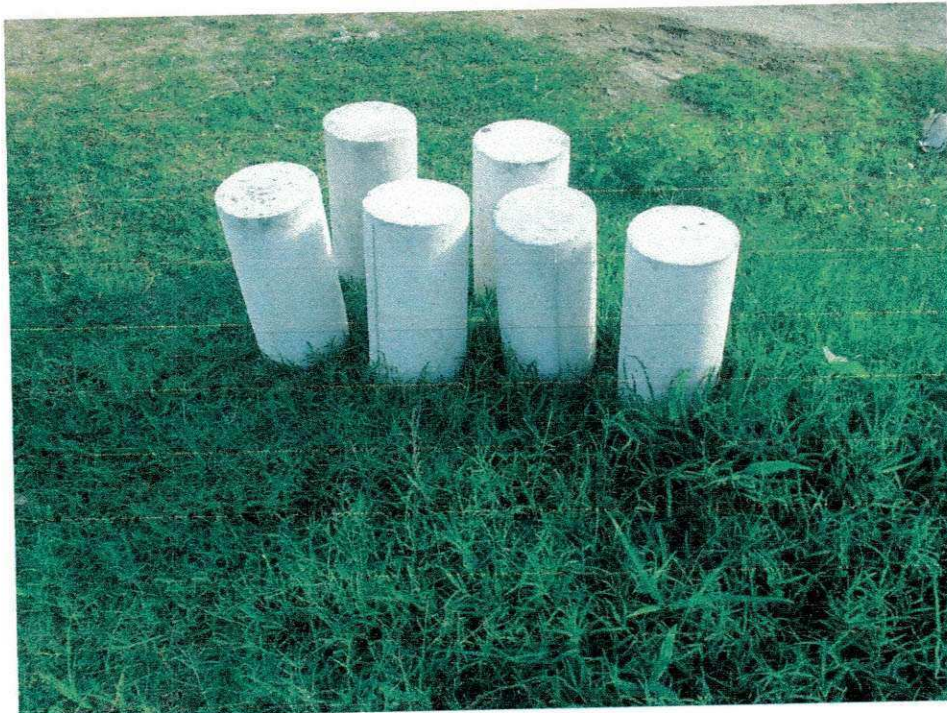
FIGURA 19 – Corpos de prova para ensaio de resistência característica do concreto (fck)
