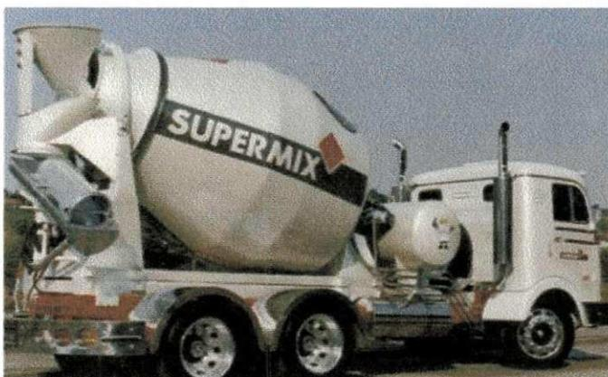
Figura 7 - Caminhão utilizado para transporte do concreto usinado
