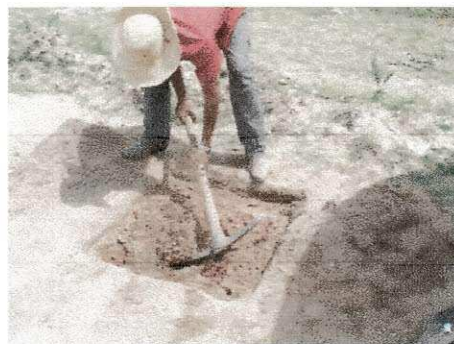
Figura 5.2 Poço de inspeção coleta de amostra do material do subleito
