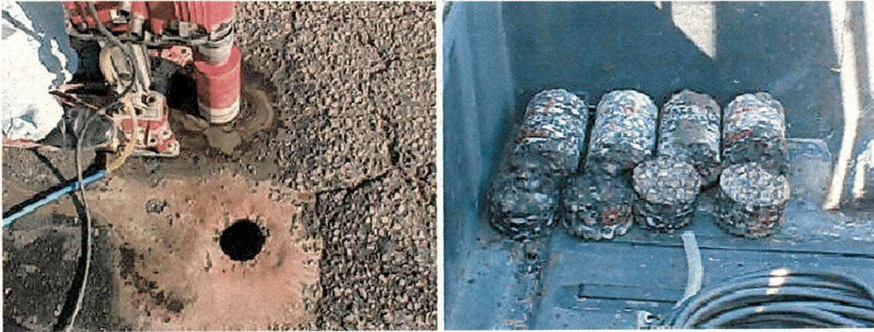
Foto 1 – Extração de corpos de prova
