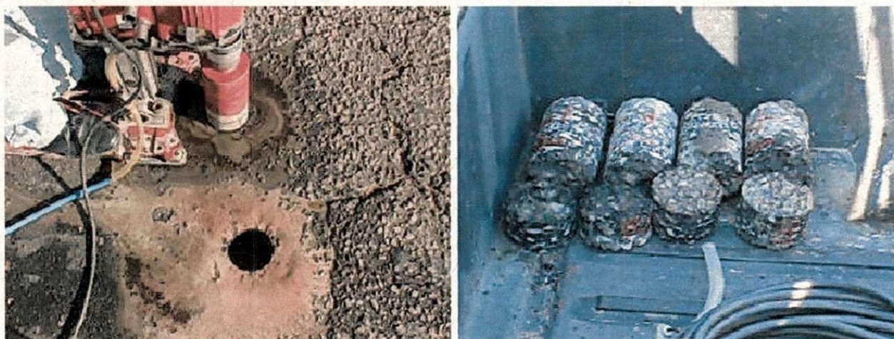
Figura 4 – Extração de Corpo de Prova
