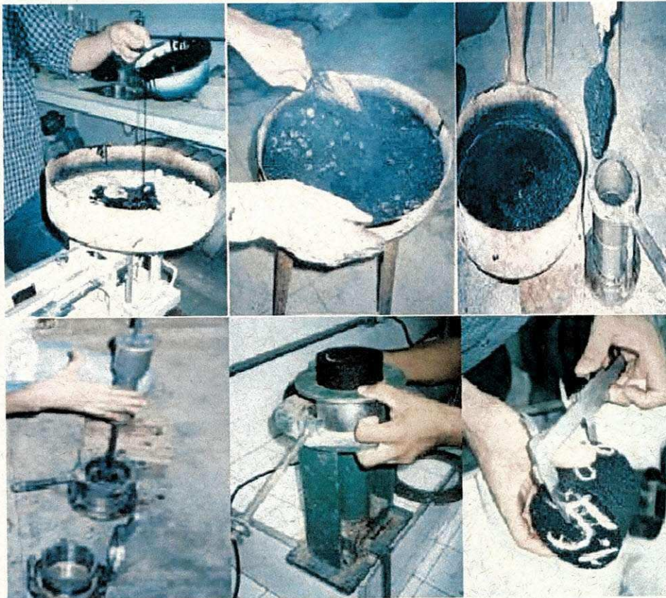
Foto 2 – Modelagem de corpos de prova em laboratório
