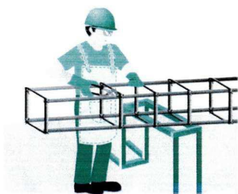
Fig. 8- montagem na mesa
