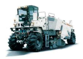
Figura 3.6 Exemplo de uma recicladora de asfalto.
