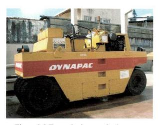
Figura 3.3 Exemplo de um rolo de pneus.
