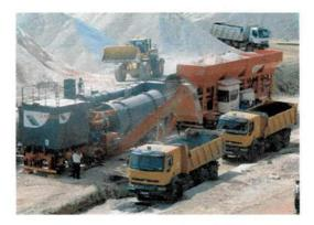
Figura 3.22 Exemplo de uma usina de asfalto contra-fluxo abastecendo caminhões.
