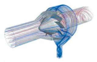
Figura 3.17 Vista interna do Separador Estático.
