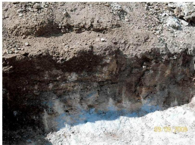
Figura 9 – estratificação do solo
