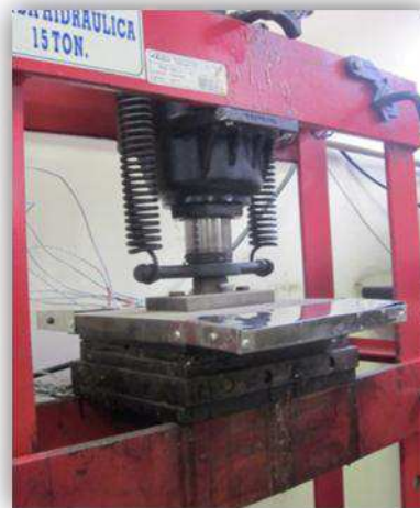
Figura 18. Prensagem do compósito
