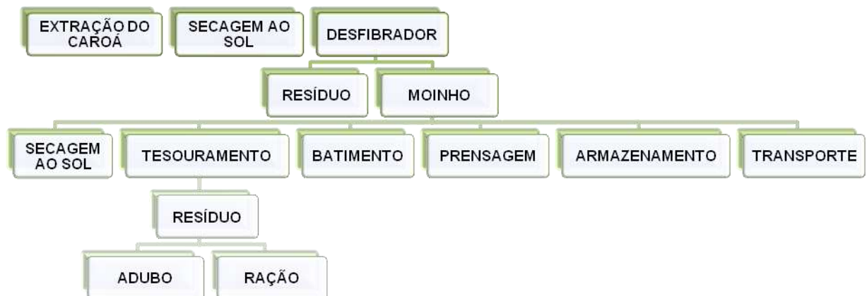
Figura 3. Diagrama do beneficiamento da fibra de caroá
