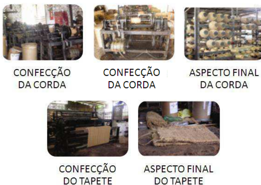
Figura 8. Confeção de cordas e tapete feitos com fibra de coco
