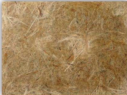
Figura 19. a) Compósito laminado poliéster/caroá b) Compósito laminado poliéster/coco
