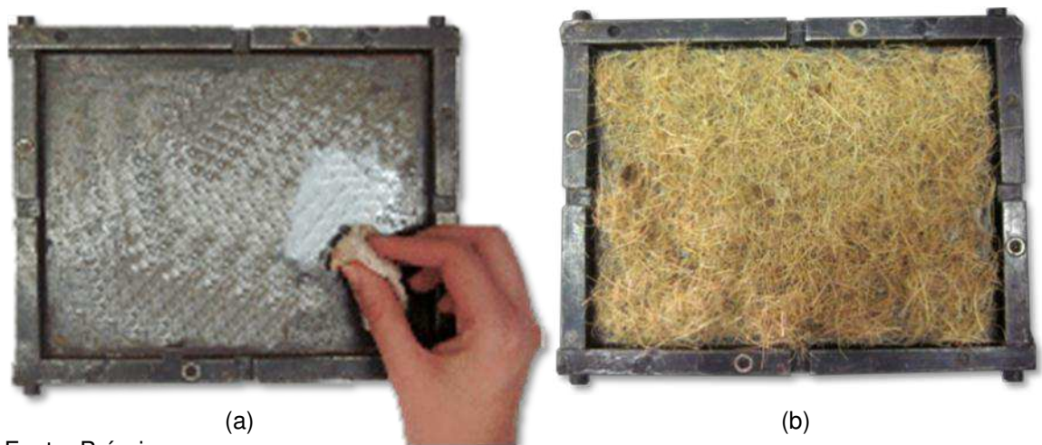
Figura 17. a) Aplicação de desmoldante b) Camadas de manta e resina com catalisador
