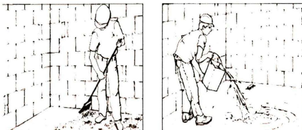
**Figura 11.** Remoção das partículas soltas e materiais pulverulentos utilizando vassouras dura e lavagem com água em abundância.
