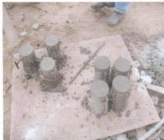
FOTO 79: FORMAS DO CORPO DE PROVA
