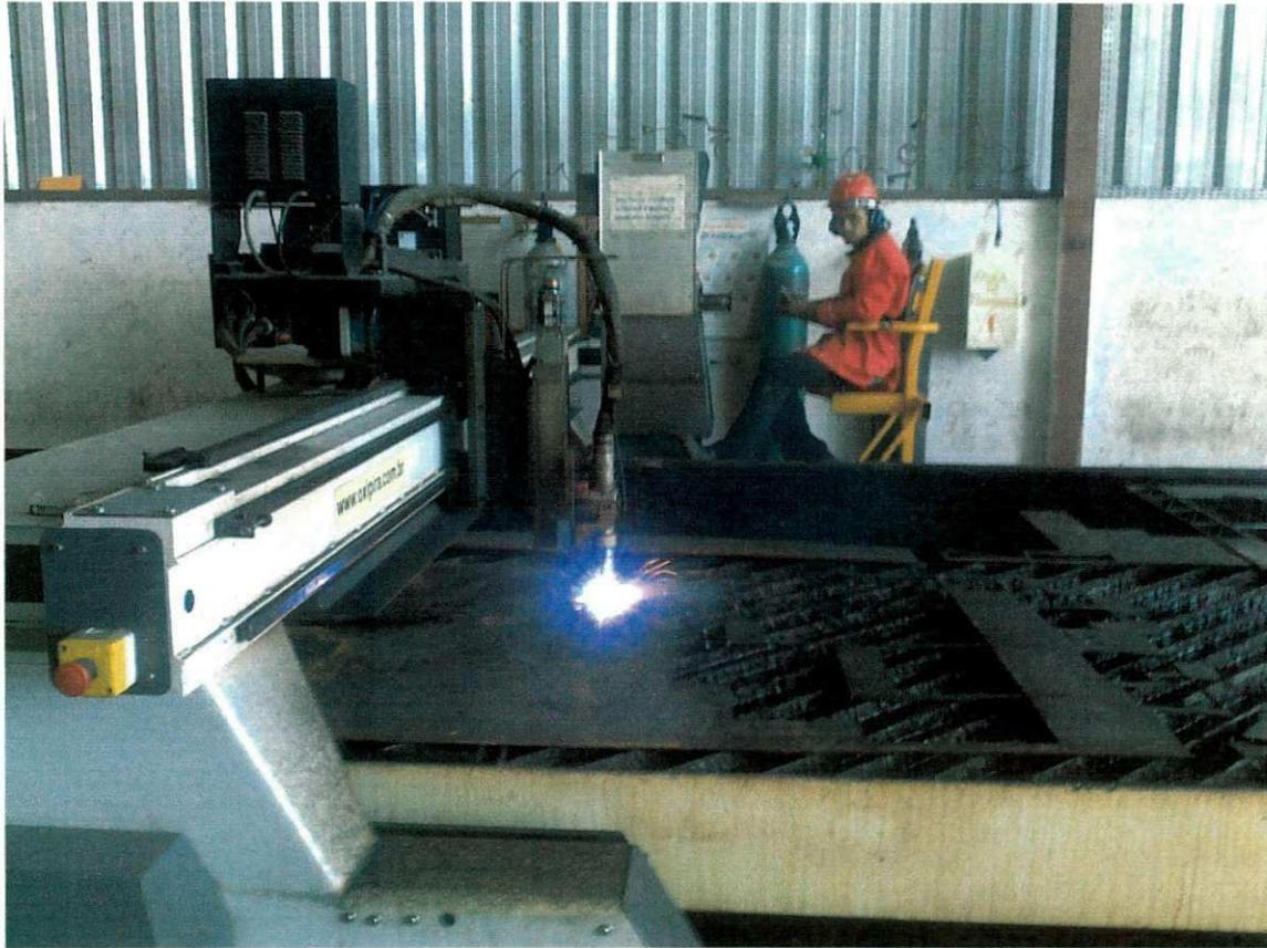
**Figura 32 - Máquina OXIPIRA em operação**
