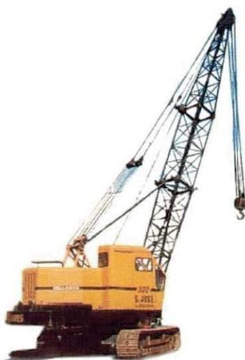
**Figura 18 - Guindaste treliçado com lança e mastro.**
