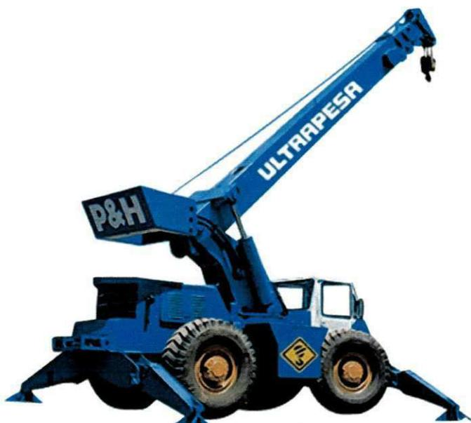
**Figura 19 - Guindaste hidráulico auto-propelido.**
