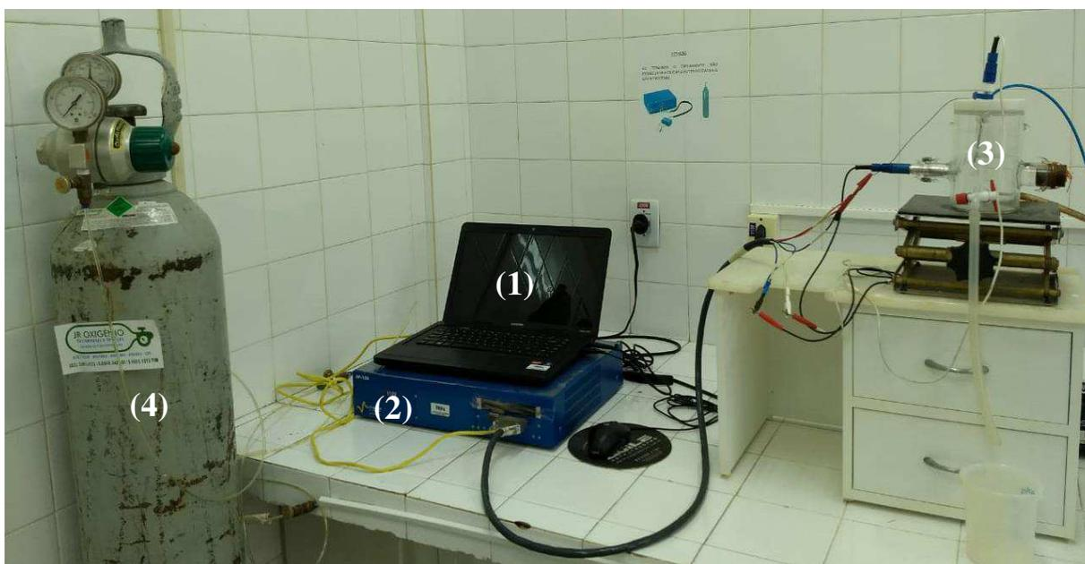
Os dados foram obtidos e processados através do software EC-Lab – *Techniques and Applications* V. 11.01 da *biologic*. Para não ocorrer a influência de reações eletroquímicas paralelas como a redução do oxigênio ( $O_2$ ), utilizou-se uma purga com gás nitrogênio ( $N_2$ ) quinze minutos antes do início dos ensaios, assim como durante todo o tempo decorrido de ensaio.
