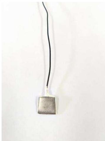
As amostras da placa de chumbo laminada foram previamente polidas com lixas d'água 3M - 600, utilizando água corrente como lubrificante e removedor de resíduos, para remover as camadas superficiais de óxidos, sulfatos e impurezas.
