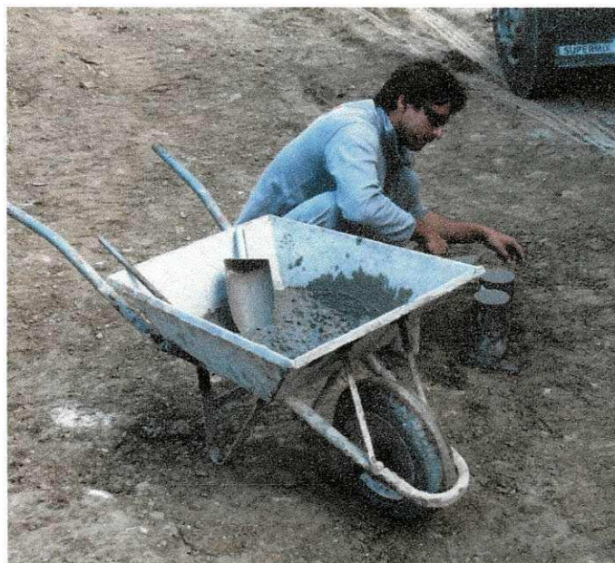
Figura 5 - Moldagem dos corpos de prova.
