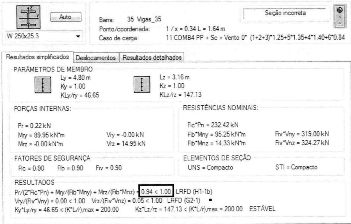
Figura 12 - Verificação da viga 35 para o estado limite ultimo
