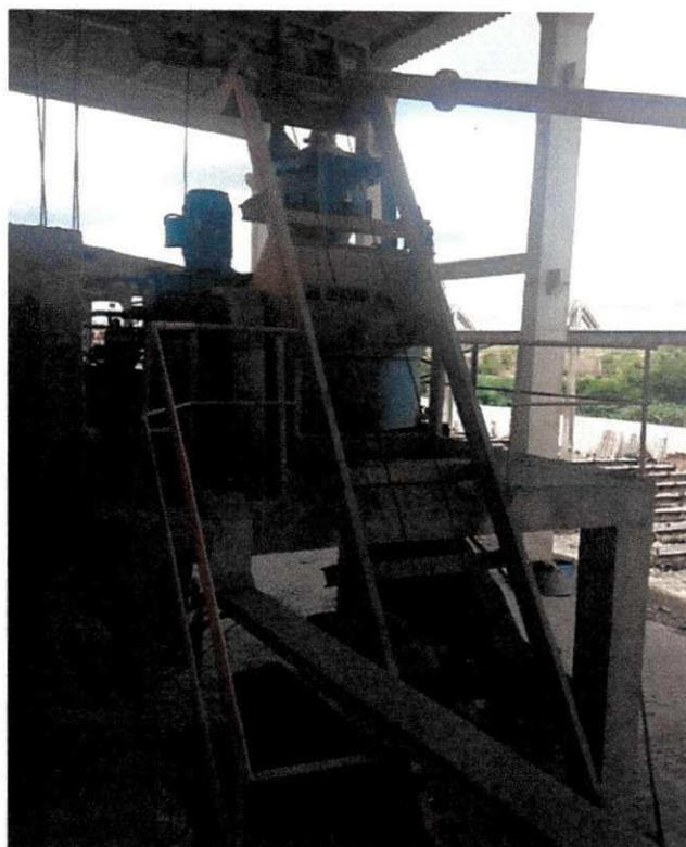
O misturador possui sensores de umidade instalados em suas palhetas que são responsáveis pelo controle do fator água/cimento. Isto porque os agregados podem conter umidade e se a quantidade de água enviada para o misturador for mantida constante haverá um aumento no fator água/cimento e uma diminuição na resistência das peças. Esses sensores mandam as informações de umidade para central de controle e a mesma regula a quantidade de água necessária para manter o fator água/cimento constante.
