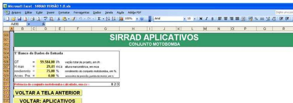
Figura 4.43 – Aplicativo: Comprimento máximo de tubulações, conjunto motobomba
