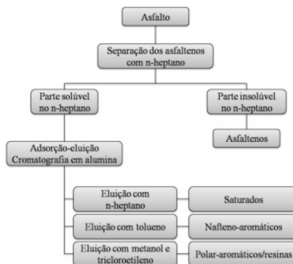
Figura 3: Esquema das principais etapas do fracionamento do ligante asfáltico
