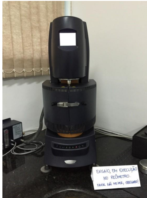
Figura 9 – Reômetro de Cisalhamento Dinâmico. Série DHR1 – TA Instruments.
