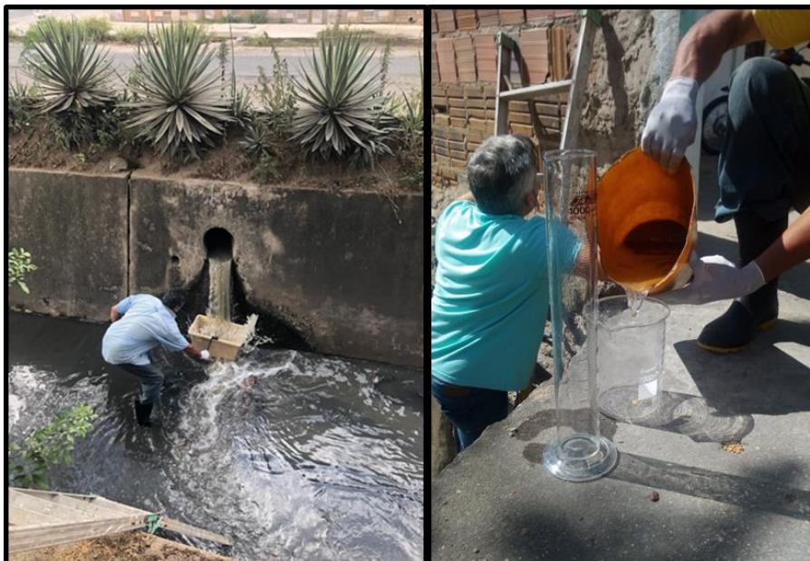
Figura 10- Determinação da vazão nas Entradas de esgoto no canal do Prado
