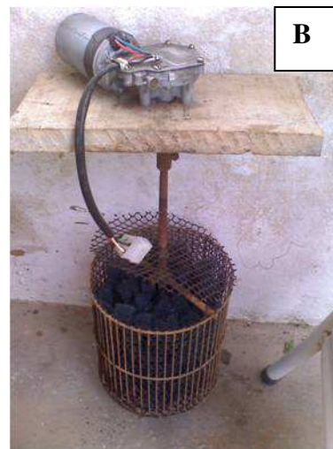
FIGURA 4.9. (A) Corte da esponja sintética para utilização como meio suporte (B) Fixação da esponja sintética no interior do reator em um recipiente fechado e conectado ao agitador mecânico.
