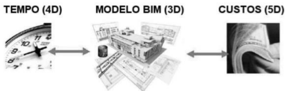
Figura 9 - Obtenção do modelo 4D de gestão e planejamento e 5D dos custos através do modelo 3D.
