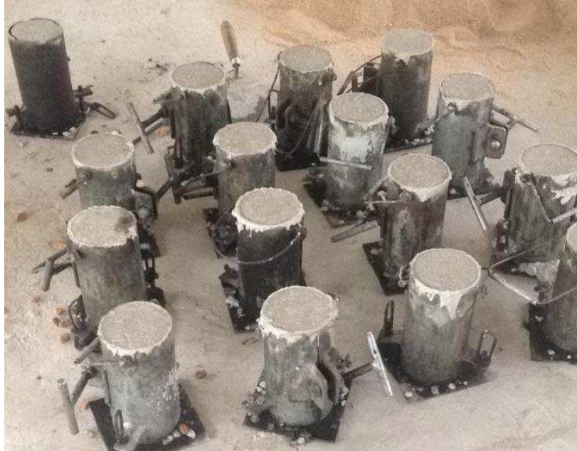
Figura 17: Corpos de prova cilíndricos com diâmetro de 10cm e altura de 20 cm, após moldagem realizada.
