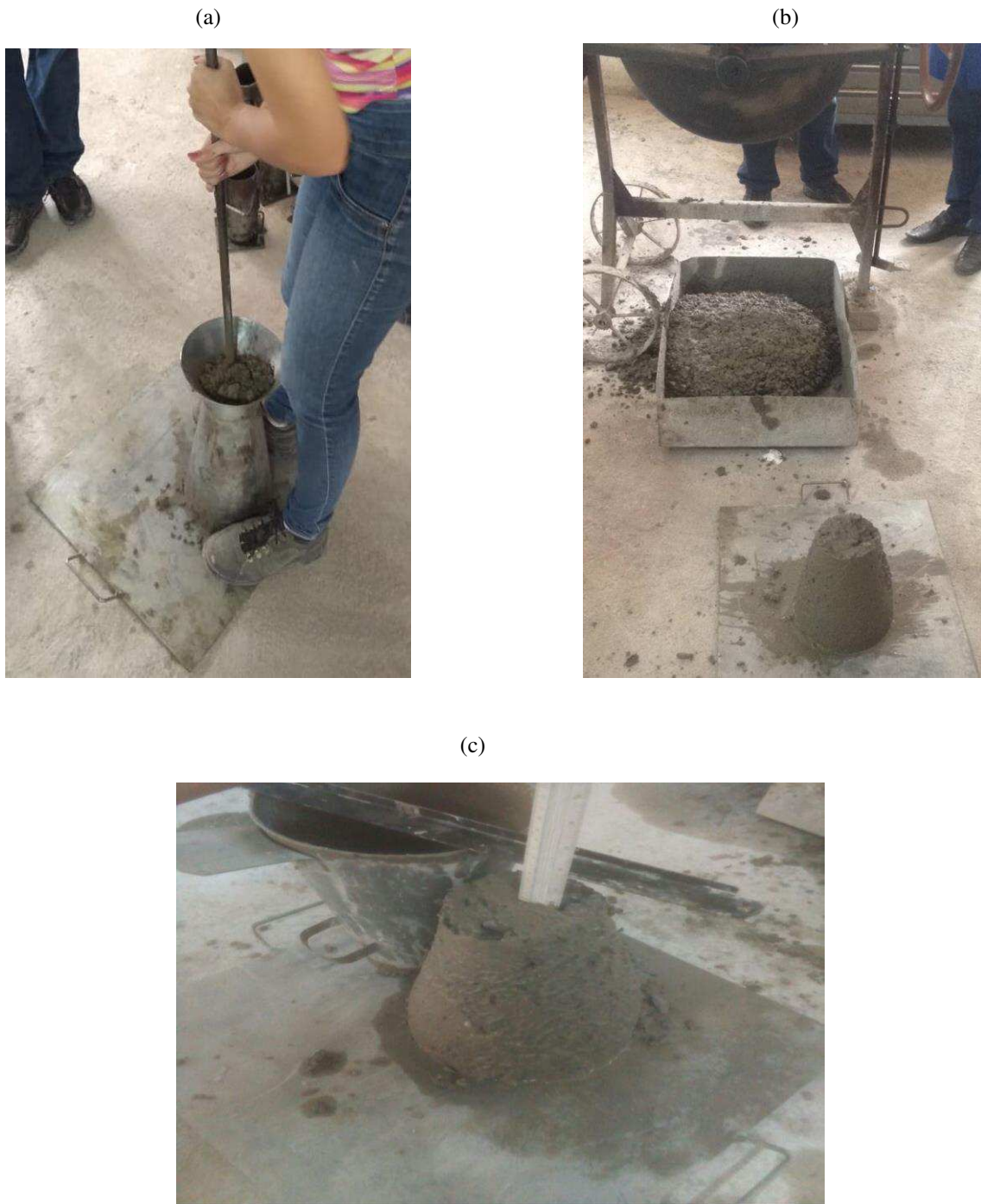
Figura 16: Resultado da britagem: (a) 25 golpes determinados pela NBR 7223; (b) Concreto após retirada do cone; (c) Abatimento analisado por meio da régua.
