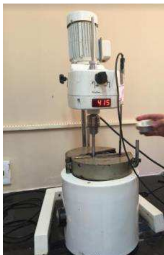
Figura 10: Misturador mecânico Fisaton modelo 722D de cisalhamento.
