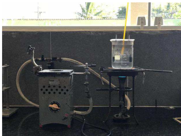
Figura 13: Estrutura para realização de ensaio de Ponto de Amolecimento.
