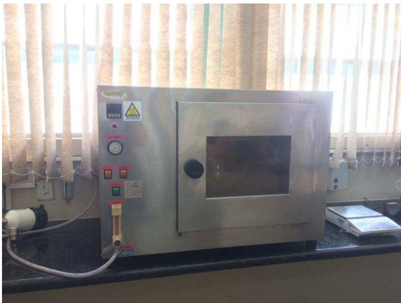
Figura 11 - Estufa para procedimento RTFO.
