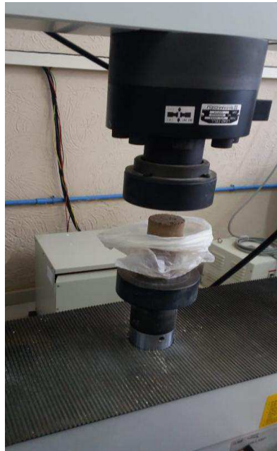
Figura 14: Prensa utilizada no ensaio de resistência à compressão simples
