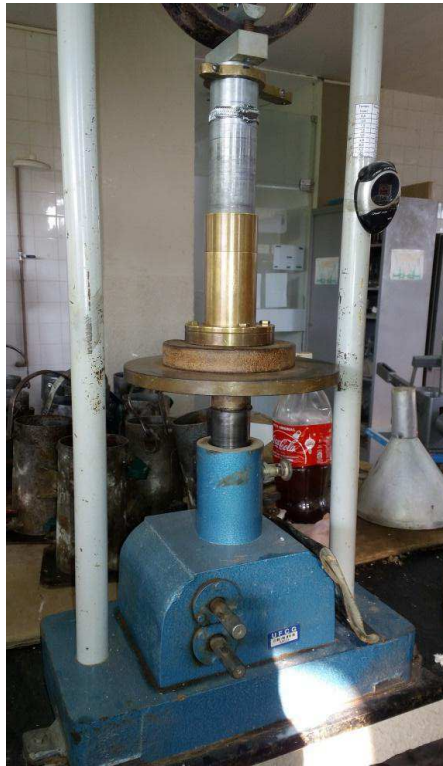
Figura 11: Moldagem do corpo de prova – Compactação
