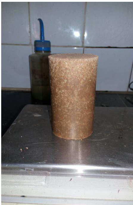
Figura 13: Corpo de prova desmoldado, na etapa de medição e pesagem
