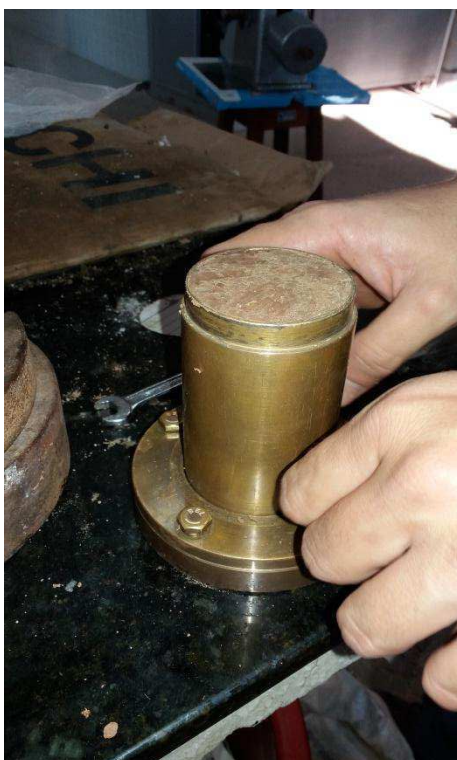
Figura 12: Corpo de prova após a compactação, antes do desmolde
