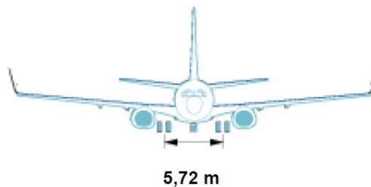
Figura 21: Geometria parcial de eixos de um avião Boeing (família 737-500, 600, 700, 800 e 900).
