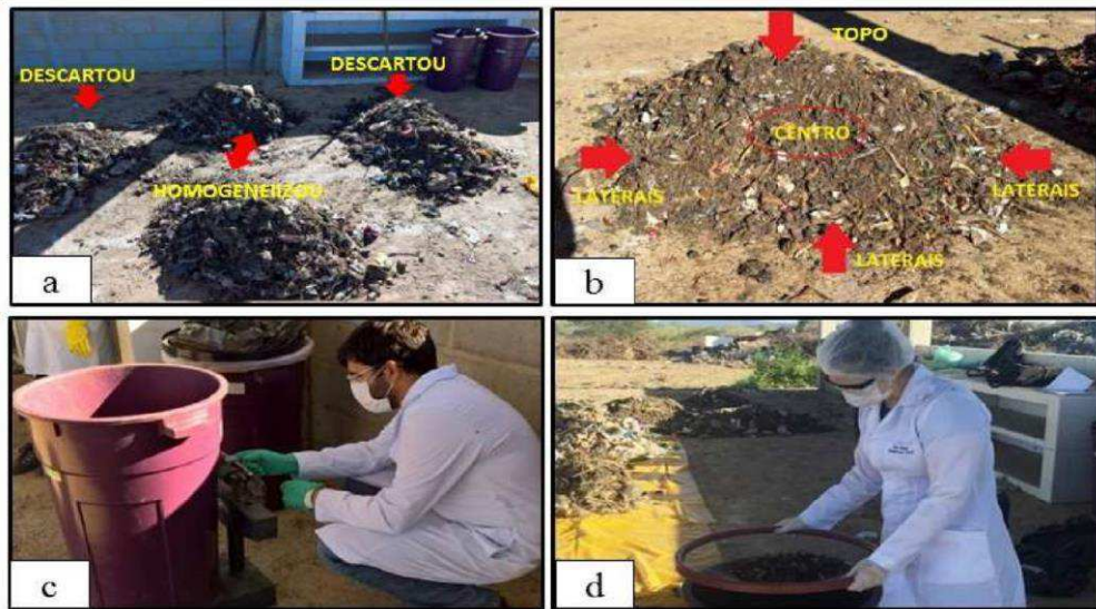
(a) Quarteamento do material misto; (b) Coleta do material do topo, das laterais e do centro da pilha; (c) Pesagem do material; (d) Peneiramento do material. Fonte: GGA (2018).
