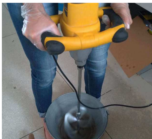
Figura 16 – Processo de amassamento de argamassa com o misturador.
