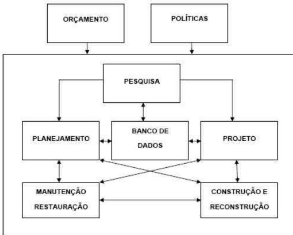
Figura 1 - Sistema de Gerência de pavimentos
