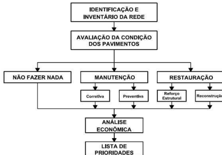
Figura 7 - Fluxograma de um SGP com alternativas das estratégias de M&R
