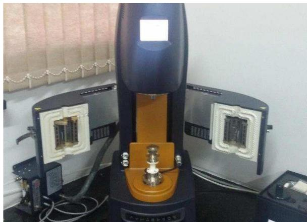
Outros testes realizados no DSR foram o MSCR (Multiple Stress Creep Recovery) e o LAS, que tem como objetivo avaliar a capacidade do material em manter sua resposta elástica e determinar a resistência à fadiga de ligantes asfálticos.
