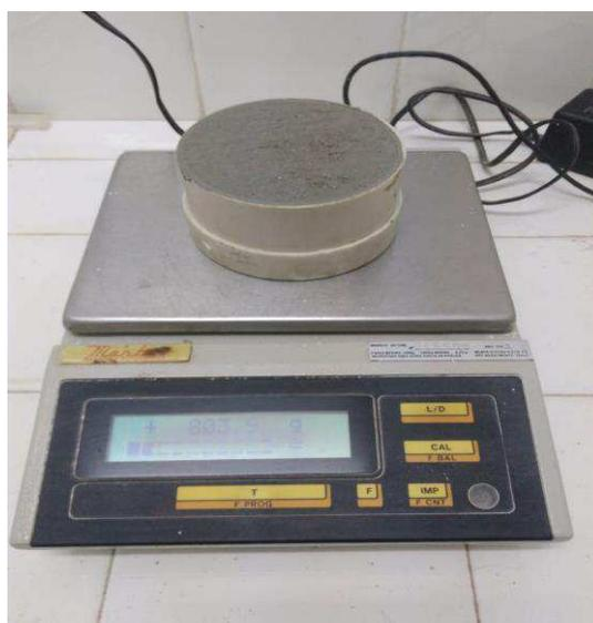
Figura 3.7: Ensaio de determinação da densidade da argamassa fresca.
