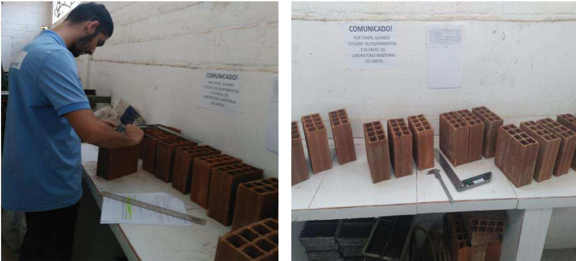
Figura 3.2: Medição da espessura das paredes externas e septos dos blocos cerâmicos realizada no Laboratório de Estruturas – UAEC – UFCG.
