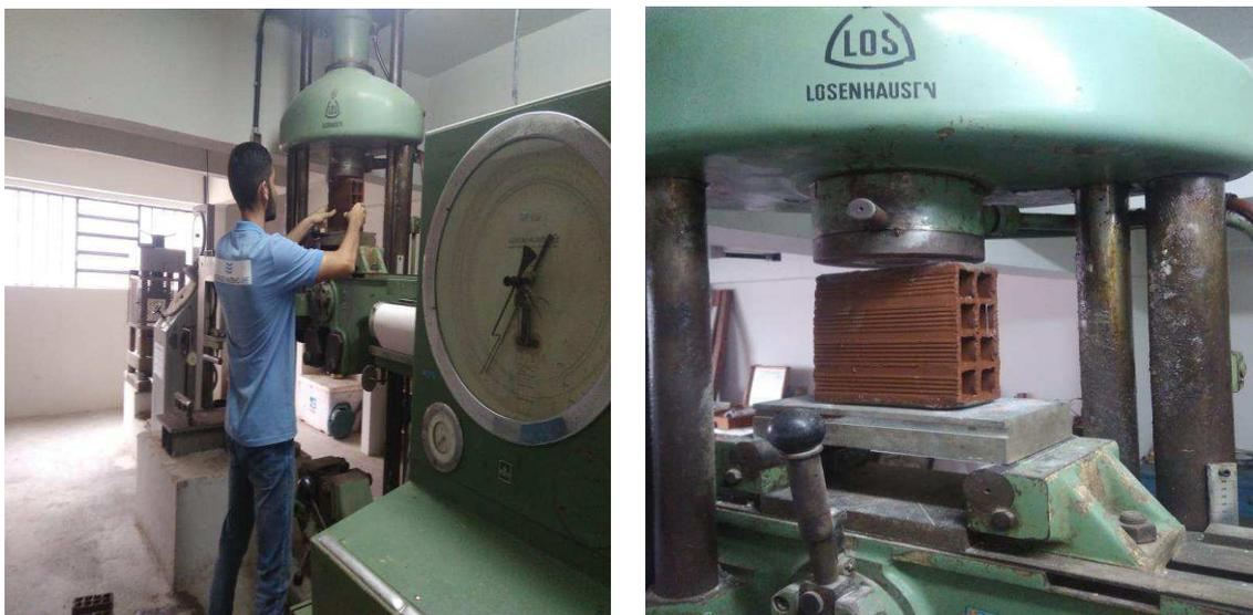
Figura 3.5: Compressão axial do bloco cerâmico executada no Laboratório de Estruturas – UAEC – UFCG.
