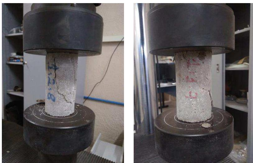
Figura 4.3: Ensaio de resistência à compressão das argamassas de assentamento na prensa Shimadzu Servopulser, no Laboratório de Engenharia de Pavimentos – UFCG.
