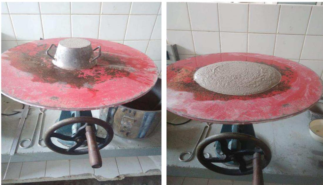
Figura 3.6: Ensaio de determinação do índice de consistência da argamassa.
