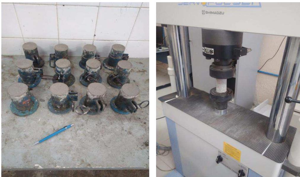
Figura 3. 8: Ensaio de compressão no corpo-de-prova executado no Laboratório de Engenharia de Pavimentos – UAEC – UFCG.
