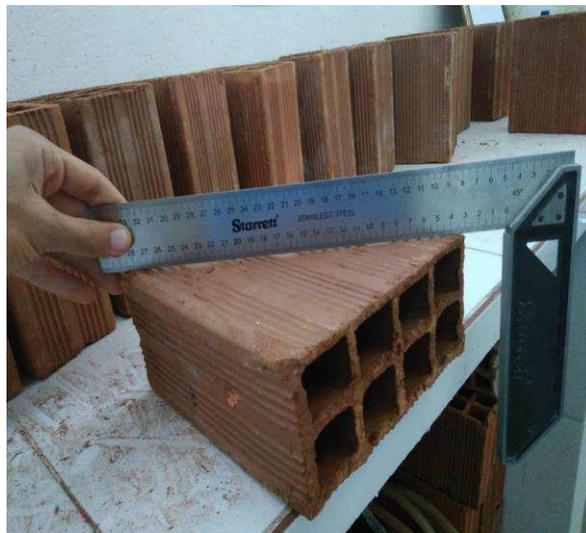
Figura 3.4: Determinação da planeza da face a partir da flecha formada na diagonal do bloco cerâmico.
