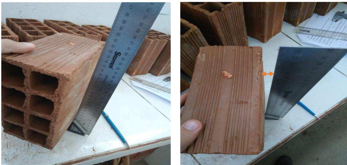
Figura 3.3: Medição do desvio em relação ao esquadro no bloco cerâmico.
