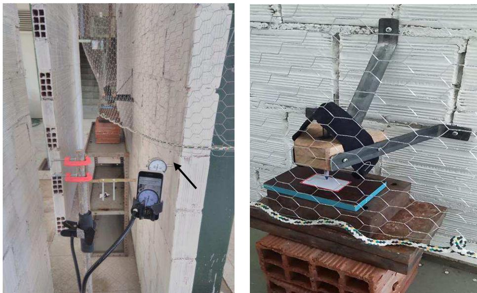
Figura 3.12: Instalação dos dispositivos de medição dos deslocamentos transversais no Laboratório de Estruturas – UAEC – UFCG.
