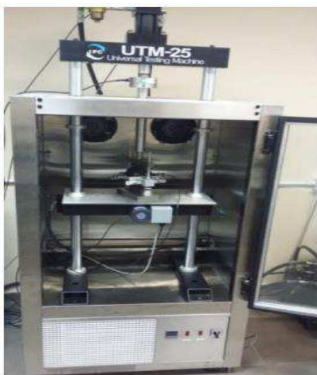
Figura 13: Prensa UTM-25 utilizada para ensaio de Módulo de Resiliência
