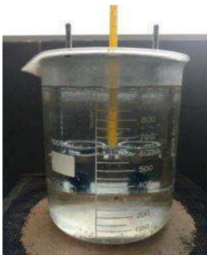
Figura 10: Conjunto anel e bola
