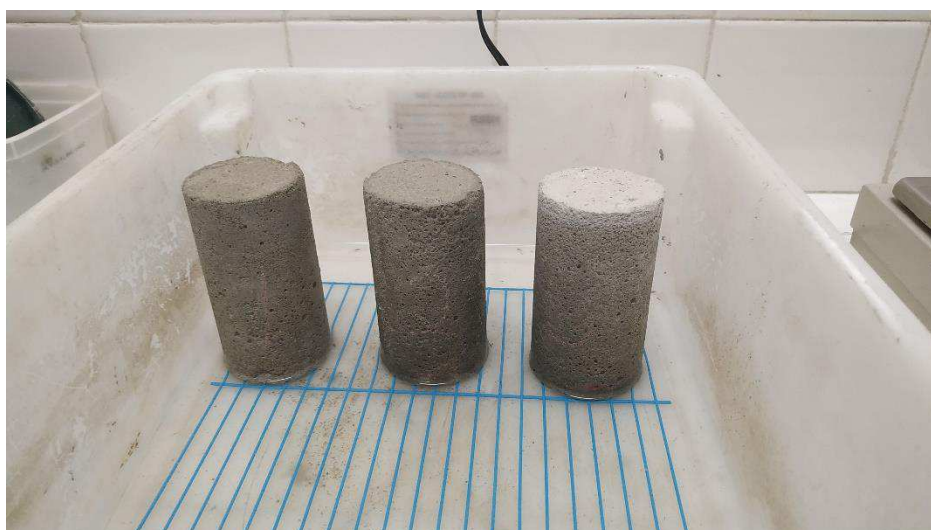
Figura 14: Corpos de prova sobre a grade, com água na altura de 5 mm.
