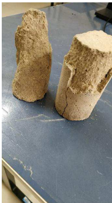
Figura 16: Corpo de prova rompido.
