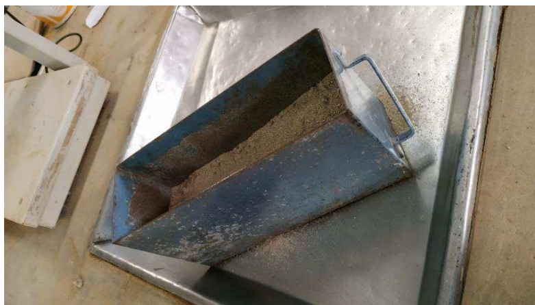
Figura 4: Caixaote preenchido com areia para ensaio de Massa Unitária.
