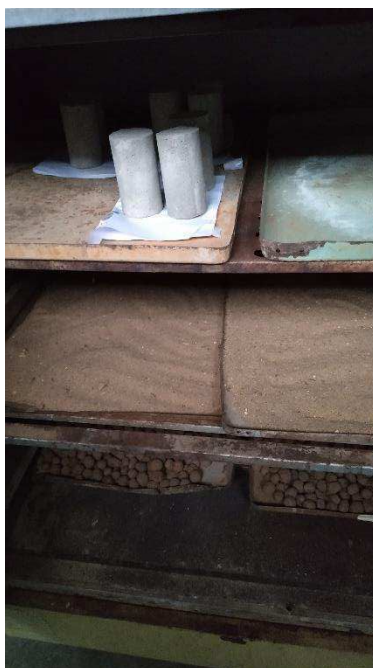
Figura 13: Corpos de Prova na estufa para serem realizados ensaios de absorção.
