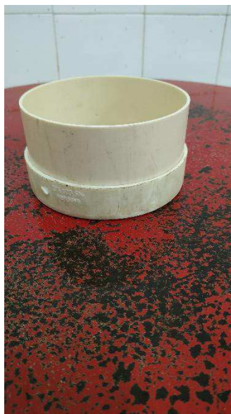
Figura 11: Recipiente para ensaio de Densidade no Estado Fresco.
