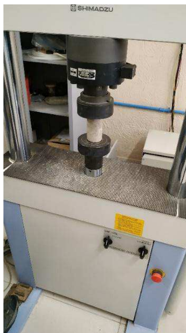
Figura 15: Ensaio de Resistência à Compressão.
