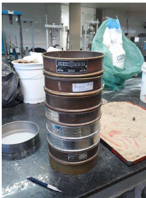
Figura 5: Série de Peneiras para ensaio de Granulometria.
