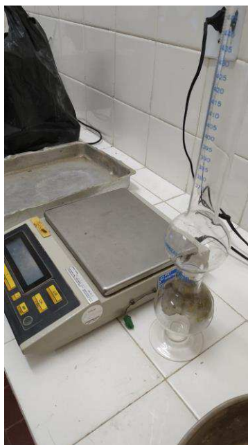
Figura 6: Frasco de Chapman para ensaio de Massa Específica da Areia.
