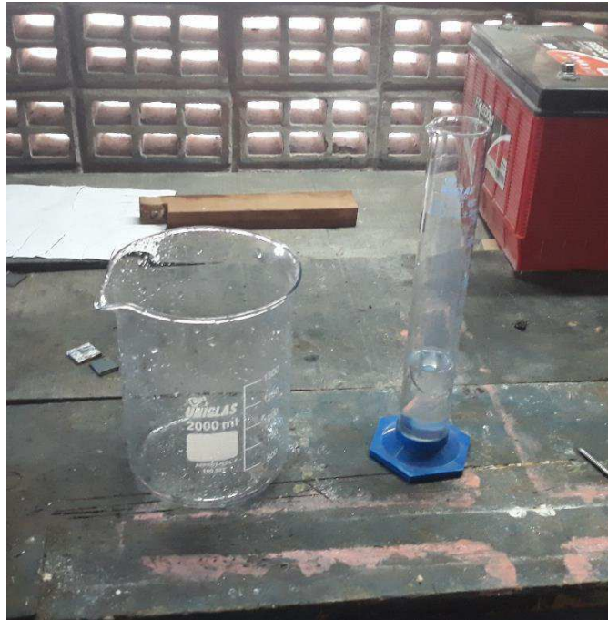
Figura 25: Becker e proveta utilizadas na medição da intensidade da chuva.
