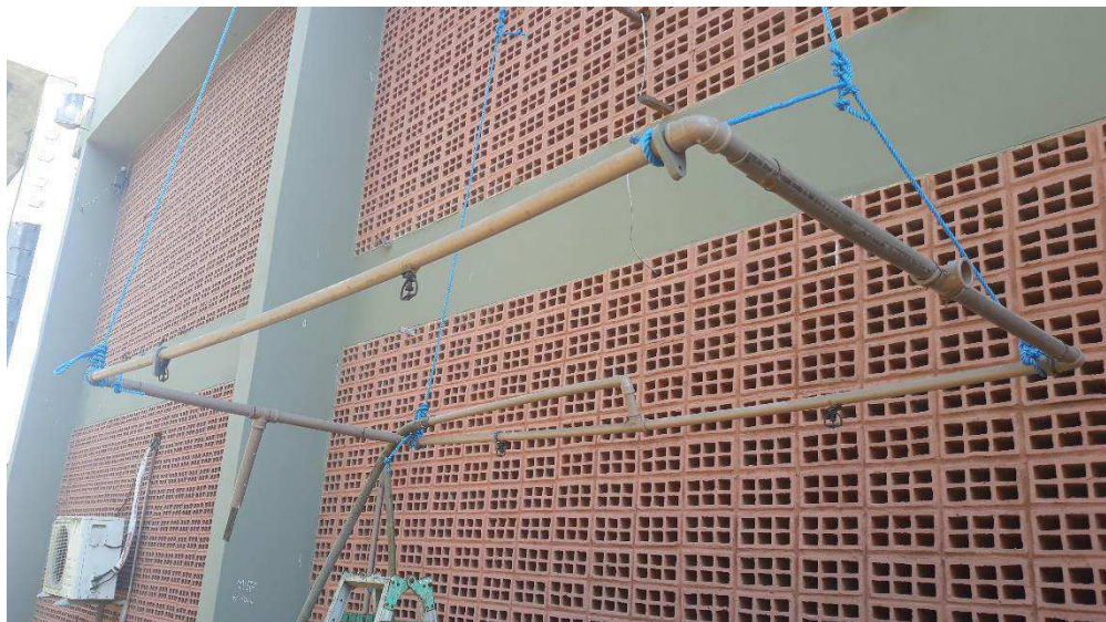
Figura 20: Sistema de canos com aspersores para simular uma chuva de projeto.
