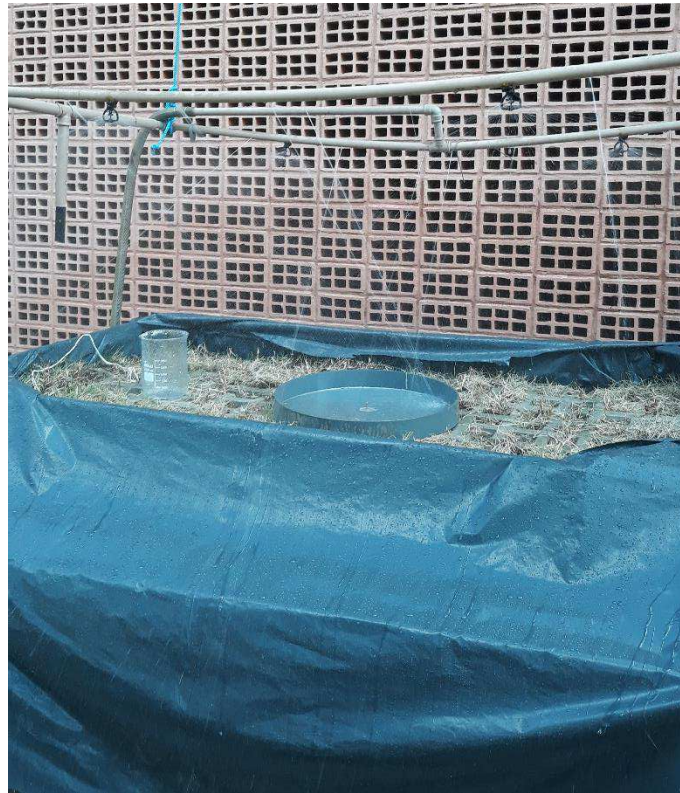
Figura 36: Recipiente circular posicionado para medição de nova intensidade de chuva.
