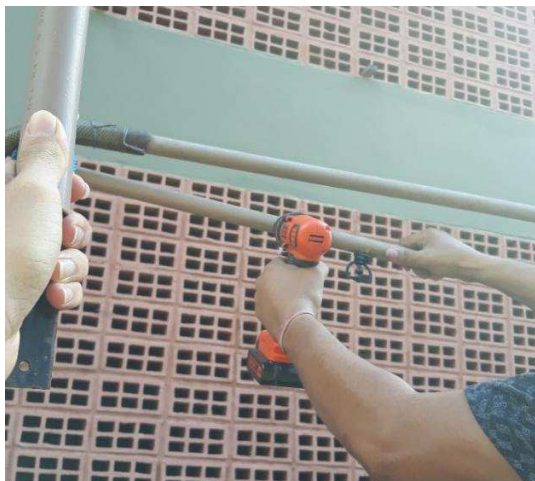
Figura 35: Realização de furos nos canos para aumentar a intensidade da chuva.
