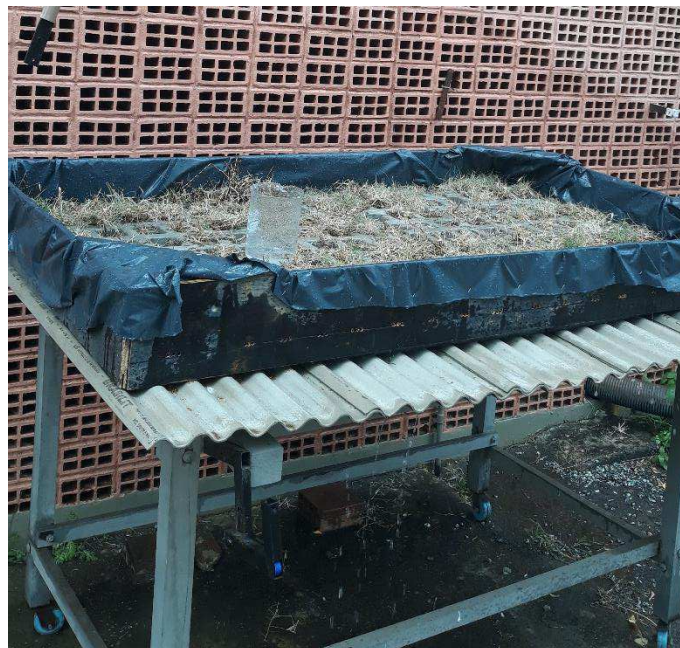
Figura 26: Becker posicionado para determinação da intensidade da chuva.
