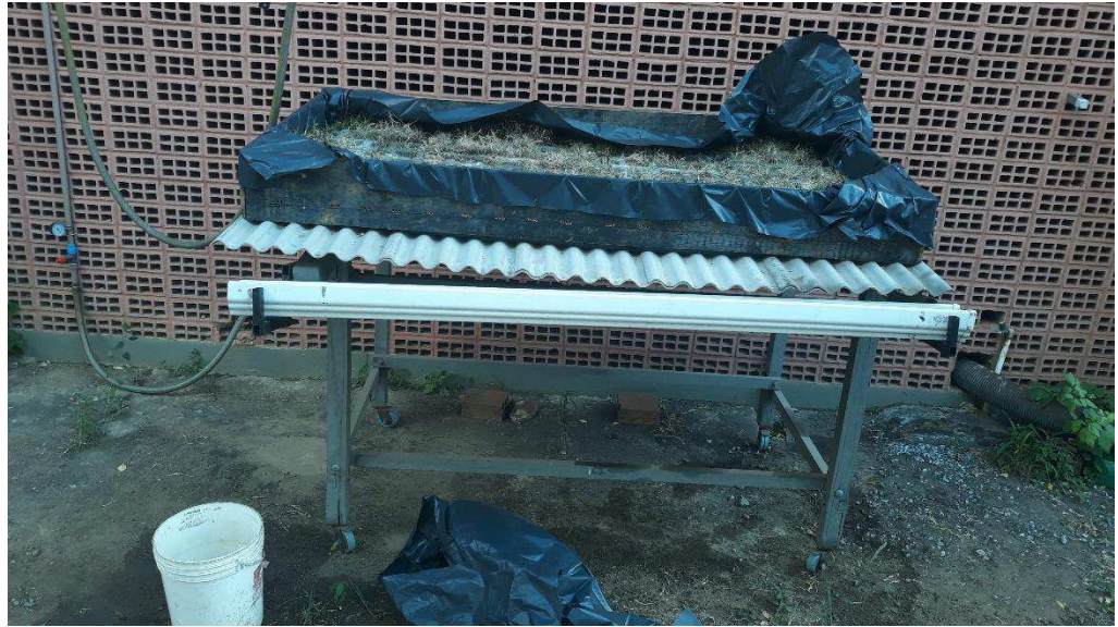
Figura 23: Estrutura com telha, calha e reservatório.
