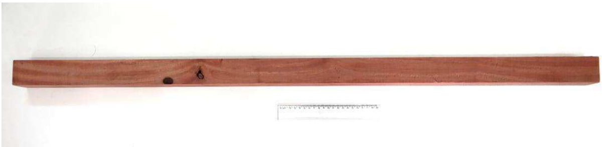
Figura 14 – Corpo de prova utilizado no ensaio de flexão.
