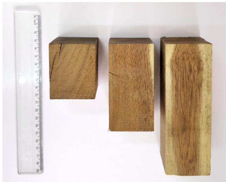
Figura 12 – Corpos de prova utilizados nos ensaios de compressão paralela, cisalhamento e coluna perfeita de Euler.
