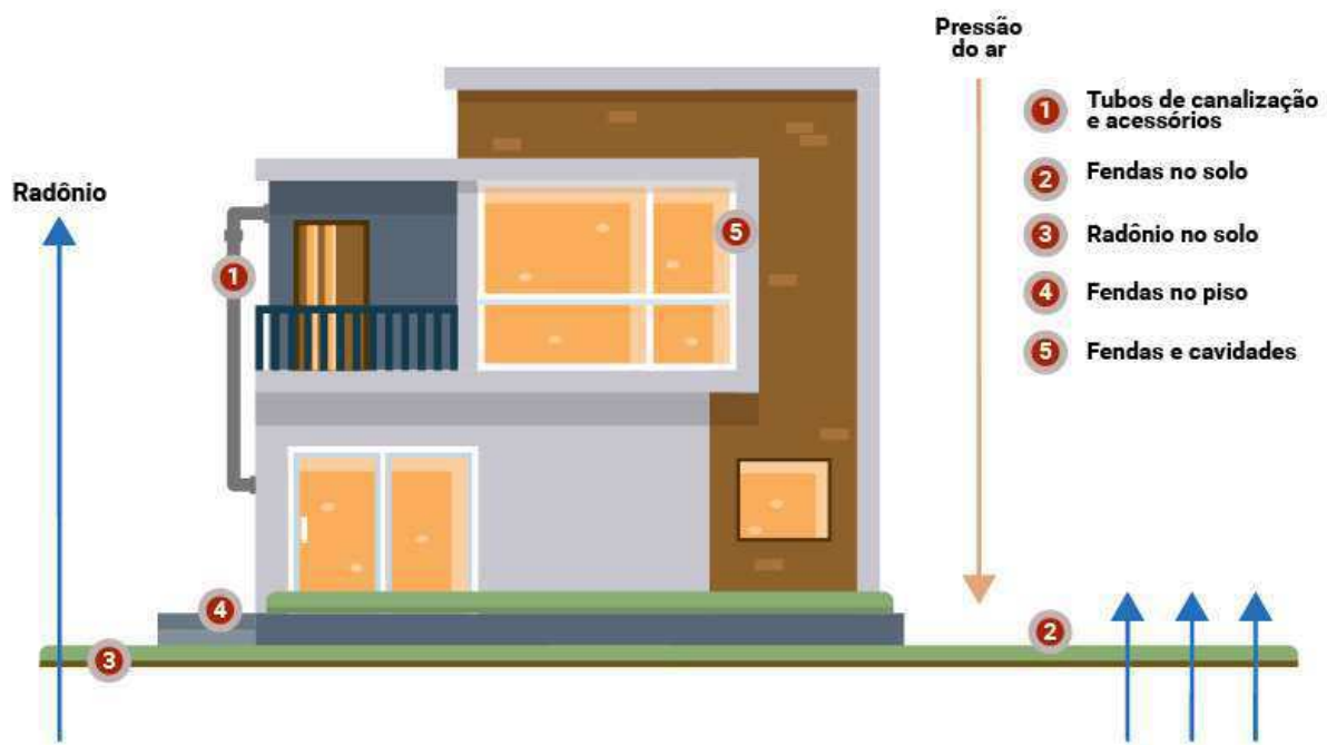
Figura 3- Causas de infiltração do radônio 222 em edificações
