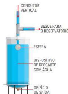
Figura 14 - Dispositivo de descarte de água.
