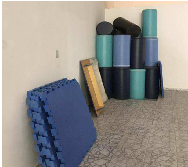
Figura 24 - Material combustível armazenado na sala de fisioterapia
