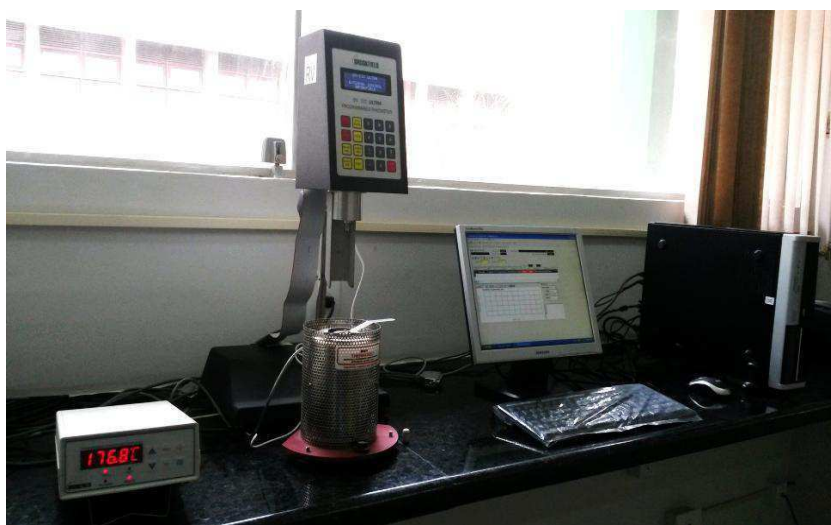
Figura 23 - Viscosímetro Brookfield utilizado no ensaio de viscosidade
