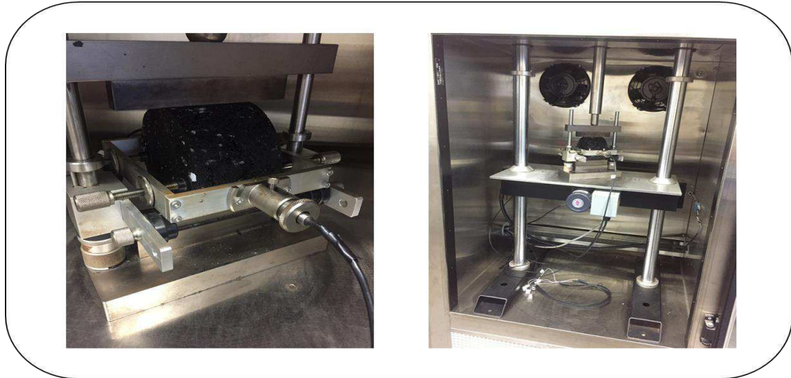
Figura 35 - Realização do ensaio de fadiga por compressão diametral na prensa UTM-25.
