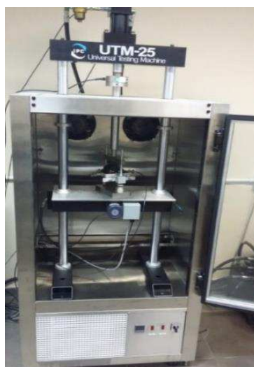
Figura 33 - Prensa UTM-25 utilizada para realização do módulo de resiliência
