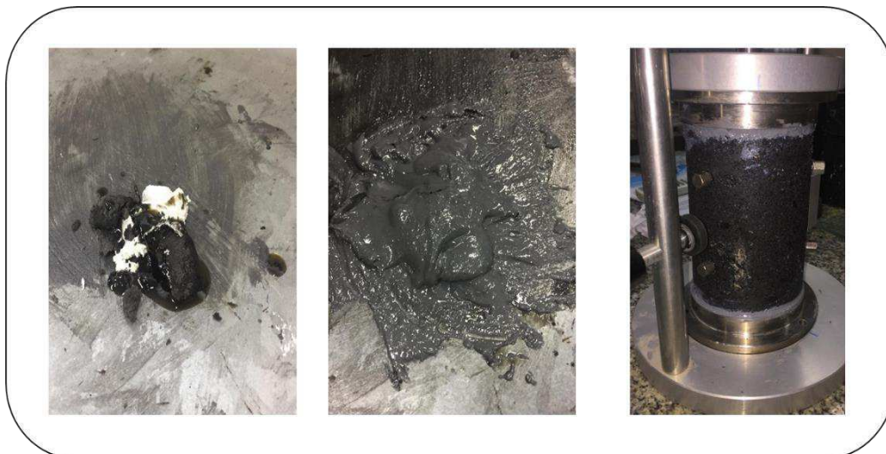
Figura 36 - Preparação da cola e posterior colagem nos pratos de fixação do corpo de prova
