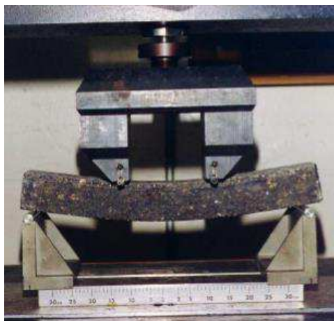
Figura 7 - Realização do ensaio de fadiga à flexão de quatro pontos em viga (MONTEIRO, 2003)
