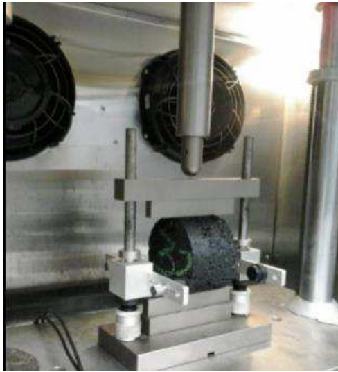
Figura 5 - ensaio de fadiga por compressão diametral
