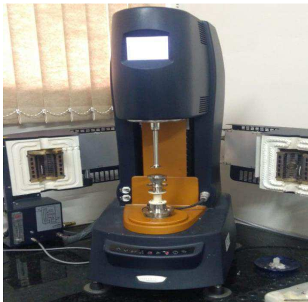
Figura 24 - Reômetro oscilatório Discovery HR-1 hybrid rheometer
